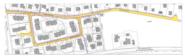
Perimeter der Sanierung Sandacker-/ Bodenackerstrasse (gelb). Die Wasserleitungen (blau) wurden im gesamten Strassenbereich plus Bodenackerweg erneuert. Die BKW erweiterte gleichzeitig die Leitungen für das Fernwärmenetz (orange), insbesondere entlang der Bodenackerstrasse.
