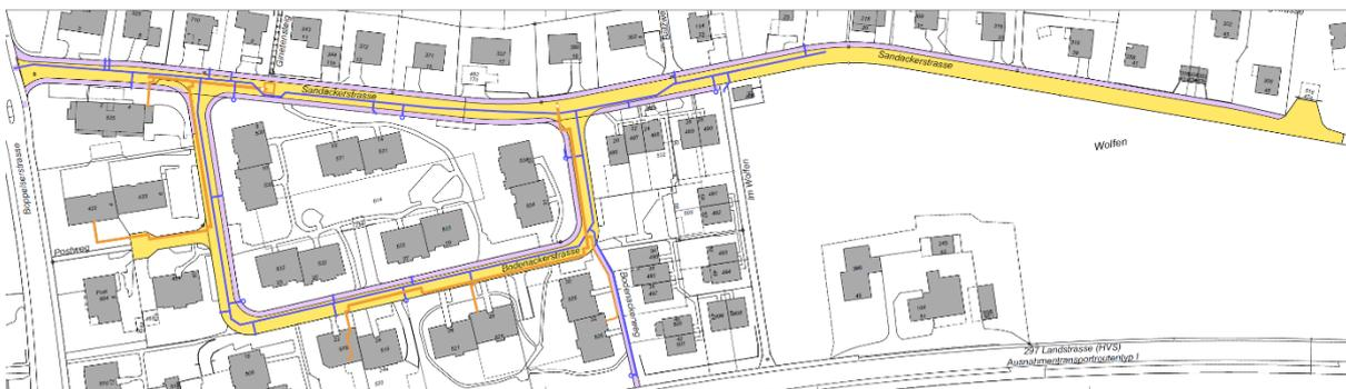
Perimeter der Sanierung Sandacker-/ Bodenackerstrasse (gelb). Die Wasserleitungen (blau) wurden im gesamten Strassenbereich plus Bodenackerweg erneuert. Die BKW erweiterte gleichzeitig die Leitungen für das Fernwärmenetz (orange), insbesondere entlang der Bodenackerstrasse.
